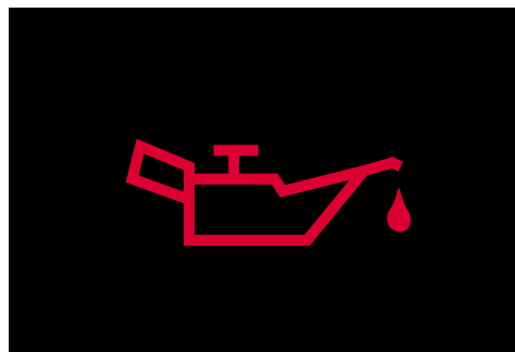
Varningslampa: fel oljetryck.
