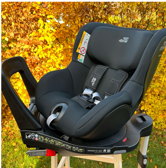
Bakåtvänd bilbarnstol. Vridbar modell med ISOFIX-fäste.
